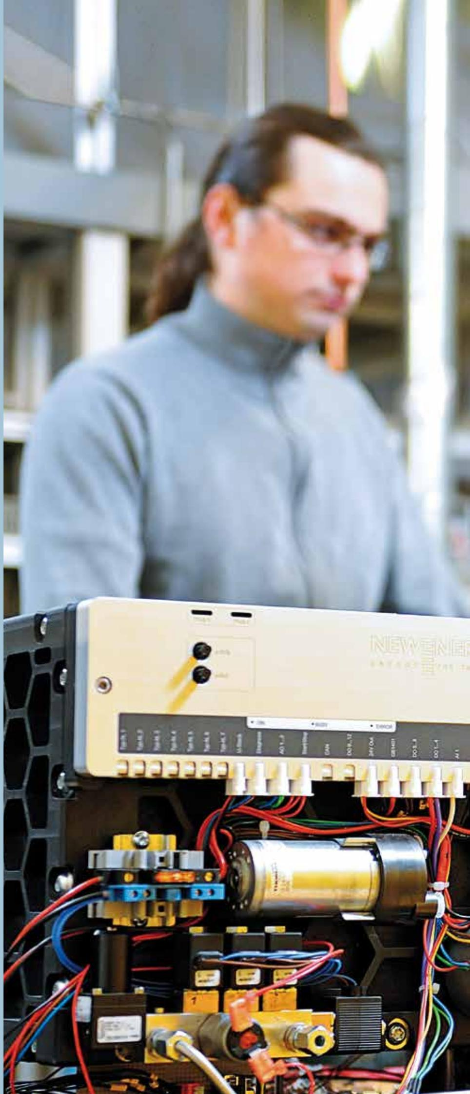
**Strom, der nicht aus der Steckdose kommt.** Wir wollen einen umweltfreundlichen Generator auf den Markt bringen, der kompakter, leiser und sparsamer ist als herkömmliche Modelle. Grundlage ist eine Hochtemperatur-Brennstoffzelle, die eine autonome Stromversorgung ermöglicht.
